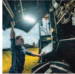
El nuevo paquete de iluminación LED bajo capó facilita aún más las operaciones de mantenimiento con poca luz.
